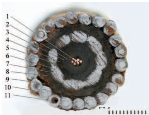
איור 5 (מימין): קטע כבל תת-ימי מסוג 'דגם צי 1989' מבוסתן-הגליל, מצפון לחיפה (צילום: אדם קוצר) איור 6 (למטה) מימין): תמונה מפורטת של הכבל התת-ימי (צילום: אהוד גלילי) איור 7 (למטה): חלקי הכבל התת- ימי בחתך רוחב (Richard Walding (צילום:
